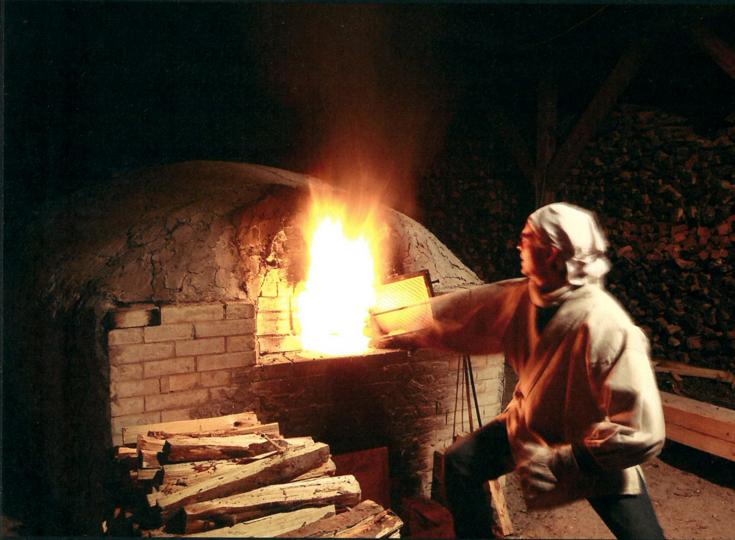
Der Ofen wird vier Tage und Nächte lang gebrannt. Alle drei Minuten wird Holz in den Ofen geworfen.
